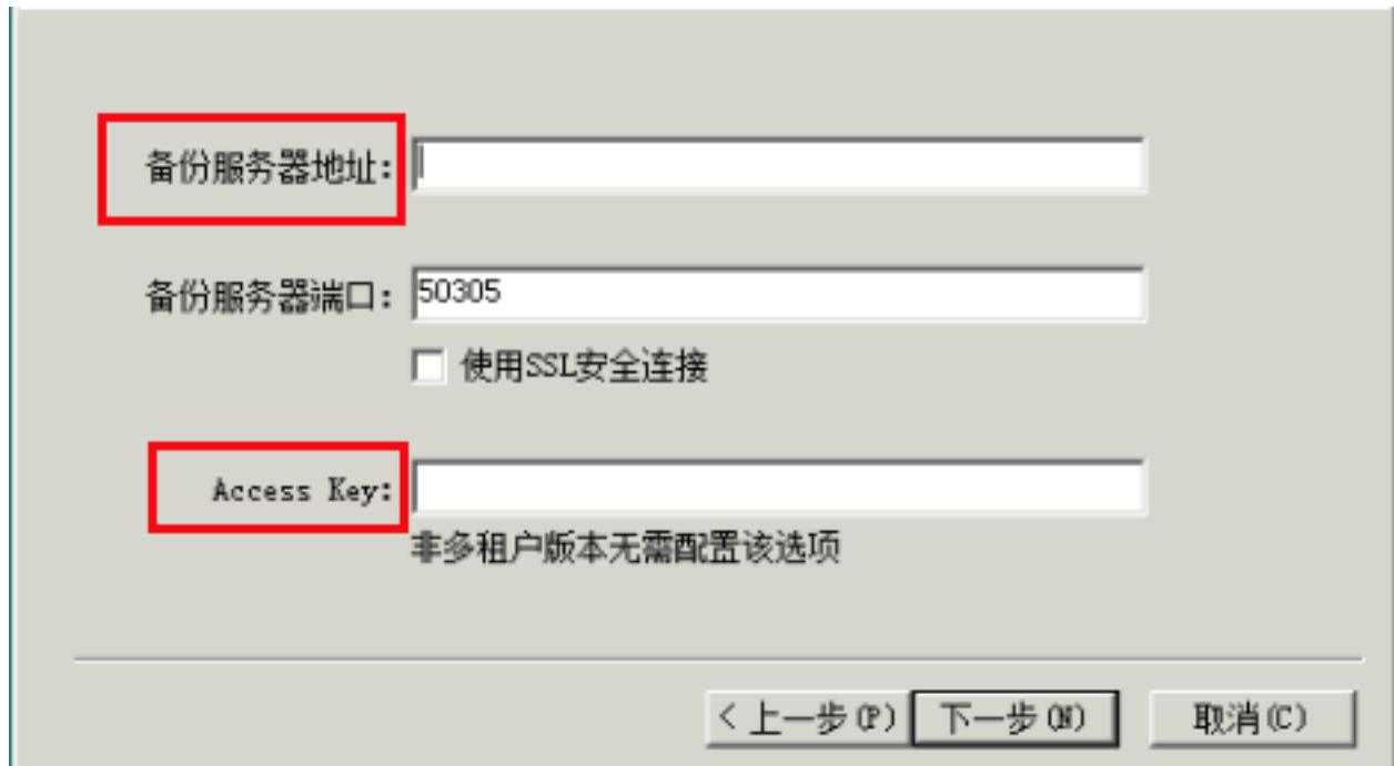
(7) 【备份服务器端口】的默认值为 50305。若勾选【使用 SSL 安全连接】，则在【备份服务器端口】输入框中填写 60305。
